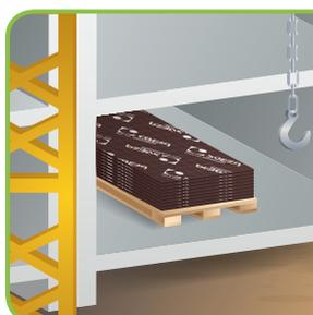
Les panneaux destinés au coffrage des étages suivants doivent être manutentionnés avec précaution à l'aide d'une grue.
