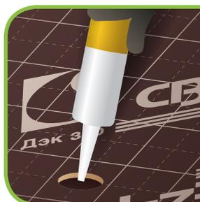
Comblers les trous réalisés au court des travaux par une colle à base de silicone afin de sceller les entrées d'humidité.
